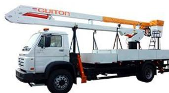
Figura 6 - Exemplo de veículo com cesto hidráulico
